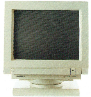
3 CM 9809. VGA Pro-Line kleurenmonitor. Resolutie 640x480 beeldpunten. Schermdiameter 34 cm. Lijnfrequentie 31,5 KHz. Rasterfrequentie 60-70 Hz. Pitch 0,29 mm. Inclusief verstelbare voet en aansluitkabel.
