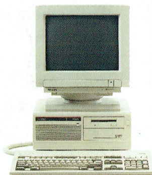
NMS 9130. Snelle PC/AT. 80286/10 processor. 3,5" diskettestation. 640 Kb RAM, uit te breiden tot 2,5 Mb. Interne hard disk van 40 Mb (28 msec). Voorbereid voor OS/2. 5 uitbreidings-slots. Compatibel met CGA, MDA, Hercules en EGA.
