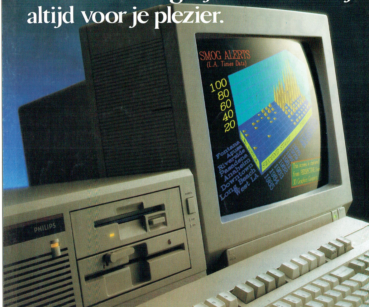
3 CM 9809. VGA Pro-Line kleurenmonitor. Resolutie 640x480 beeldpunten. Schermdiameter 34 cm. Lijnfrequentie 31,5 KHz. Rasterfrequentie 60-70 Hz. Pitch 0,29 mm. Inclusief verstelbare voet en aansluitkabel.
