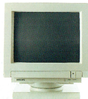
3 CM 9809. VGA Pro-Line kleurenmonitor. Resolutie 640x480 beeldpunten. Schermdiameter 34 cm. Lijnfrequentie 31,5 KHz. Rasterfrequentie 60-70 Hz. Pitch 0,29 mm. Inclusief verstelbare voet en aansluitkabel.
