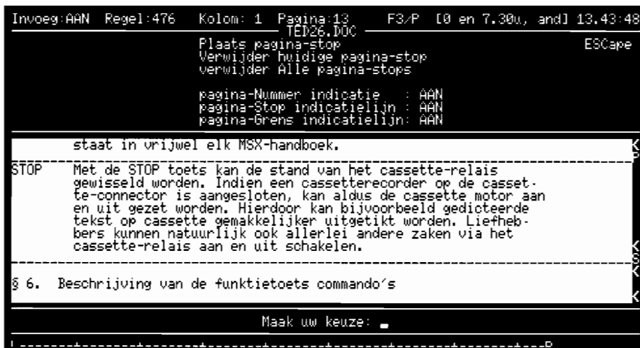
Figuur 3: Het paginamenu. Pagina-stops worden weergegeven door een 'S' in de statusbalk, paginagrenzen door een 'P'. Pagina-stops kunnen ook geplaatst worden door middel van Ctrl+Return.
