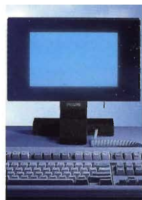
Er zijn 2 uitvoeringen: de LCD 100, die MDA-CGA emuleert en 7 grijsstinten onderscheidt. En de LCD 150, voor CGA-EGA emulatie met 8 grijsstinten.
