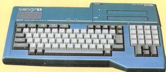
◎WAVY23。写真のブルーメタリックは、最近発売になったもの。幅415×高さ63×奥行き266(mm)、重さ3.0kgと他の機種よりひとまわり大きい。内蔵ソフトはないが、操作性を考えたWAVYシリーズでおなじみのユニークなデザインが光る
