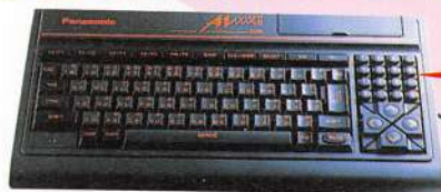
◎FS-A1MKII。幅383×高さ64×奥行き×228(mm)、重さ1.6kgとかなりコンパクト。連射パッドや丸いテンキーがおもしろい
