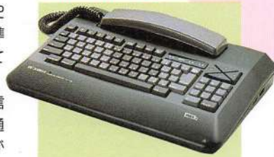
②ML-TS2H。幅357×高さ86×奥行き243(mm)。重さは3.5kg。付属のアダプターで2スロットになる
