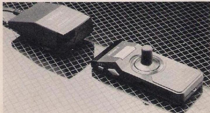
Joystick JS 75 à commande infrarouge
