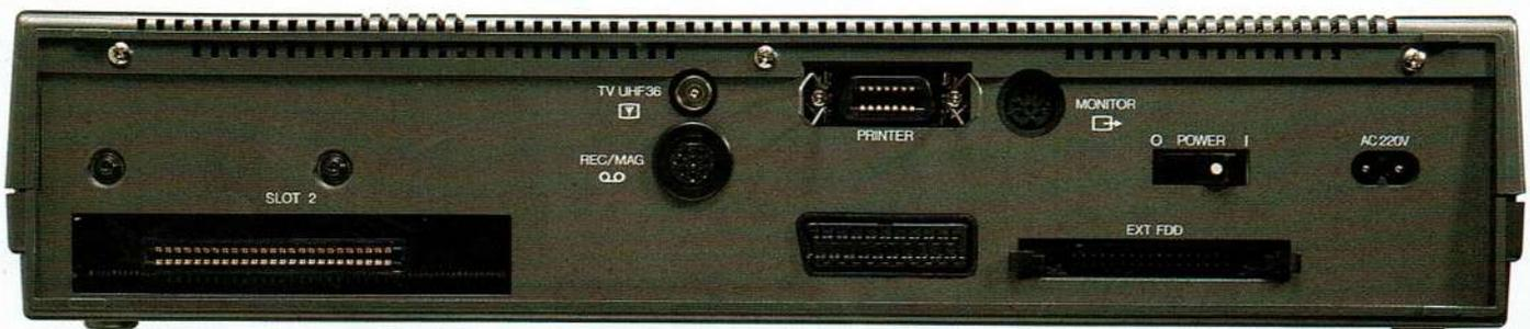
conexión directa, así como salidas para monitores monocromos y en color (RGB) y una conexión para TV.
